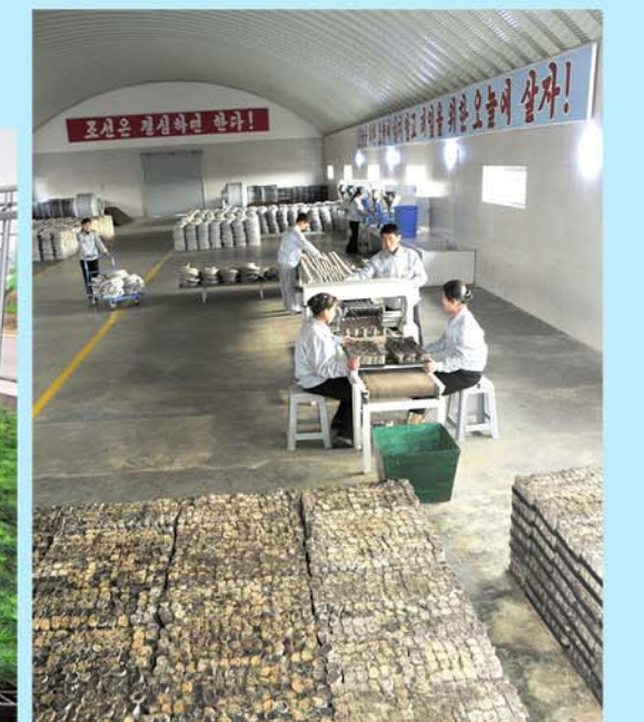
Процесс производства перегнойного горшочка для саженцев.
